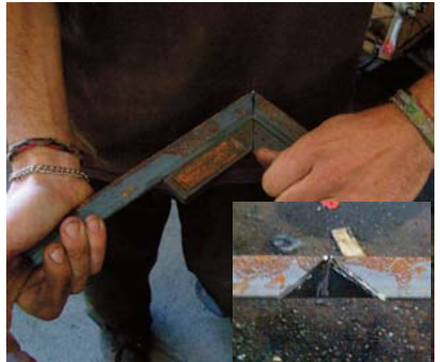
como se muestra, de las esquinas de ángulos de 90 grados se corta, se dobla y se suelda el ángulo de hierro.
